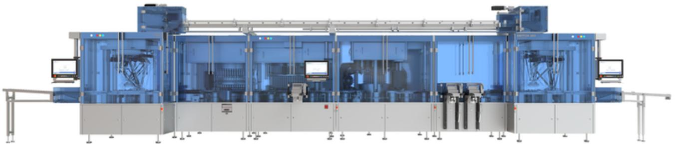
Switch 350: Eine flexible Hochleistungs-Inspektionsmaschine für Spritzen und Vials mit bis zu 350 Behältern/Min. mit De- und Renestern für Vials und Spritzen gleichermaßen. Profitieren Sie von einer umfassenden Lösung für die Inspektion von Arzneimittelbehältern, die den Einsatz mehrerer Maschinen überflüssig macht und gleichzeitig eine hohe Effizienz und Qualität gewährleistet.
