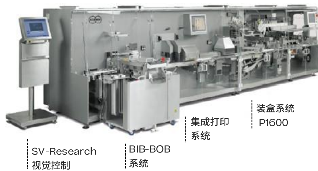
柯尔柏的包装线无缝集成了 LSC 概念，采用了 BIB-BOB 模块
